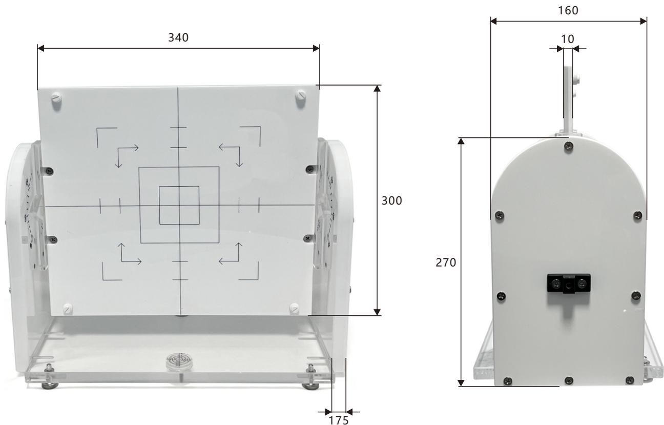
图A.1 等中心校准仪示意图
